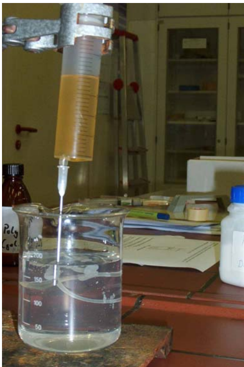
Abb.10: Fällung von Polyacrylnitril als Faden
